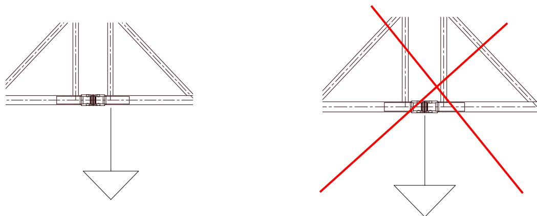
Alle Lasten sind gleichmäßig auf beide Gurte zu verteilen.
