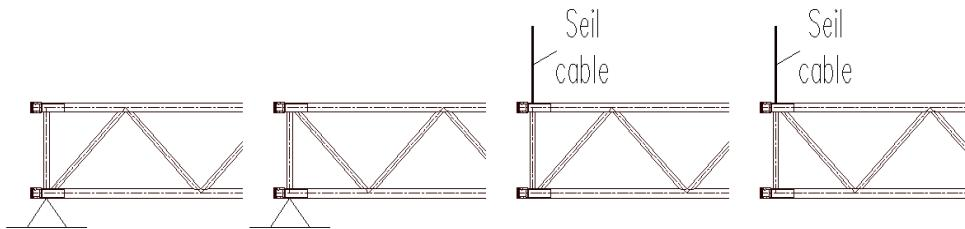
Bei Einschränkung der Position der Kupplung (siehe Kapitel 4, Fall 2), ist die Kupplung so anzutragen, dass sie von der Lasteinleitungsstelle aus gesehen  $\geq 1,0$  m in Richtung des Auflagers liegt.
