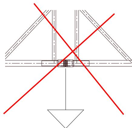
Alle Lasten sind gleichmäßig auf beide Gurte zu verteilen.
