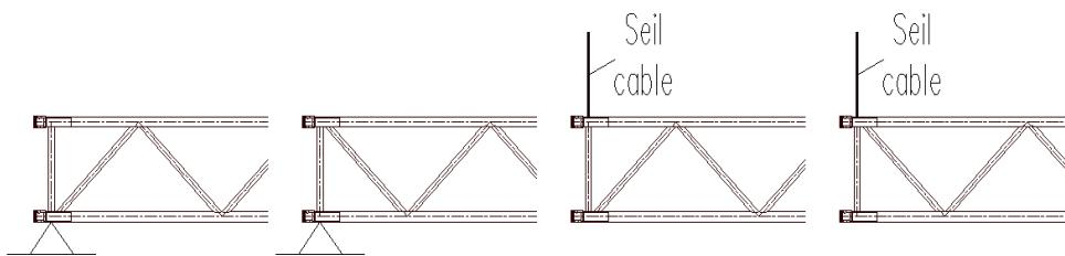
Bei Einschränkung der Position der Kupplung (siehe Kapitel 4, Fall 2), ist die Kupplung so anzurordnen, dass sie von der Lasteinleitungsstelle aus gesehen  $\geq 1,0$  m in Richtung des Auflagers liegt.
