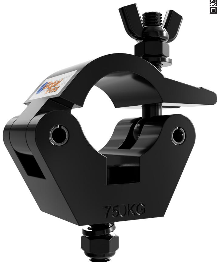
Mit dem Half Coupler Heavy Hex hat Global Truss ein massives Arbeitstier im Portfolio. Mit einer Lastaufnahme von 750 kg und einer Breite von 50 mm ist er ideal für hohe Lasten geeignet. Der Schließmechanismus ist bei diesem Coupler durch eine M12 Mutter sowie eine zusätzliche Flügelmutter gesichert.
