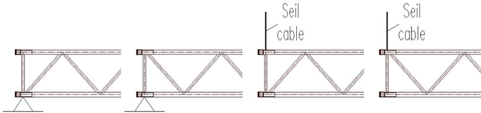
Bei Einschränkung der Position der Kupplung (siehe Kapitel 4, Fall 2), ist die Kupplung so anzuordnen, dass sie von der Lasteinleitungsstelle aus gesehen  $\geq 1,0$  m in Richtung des Auflagers liegt.
